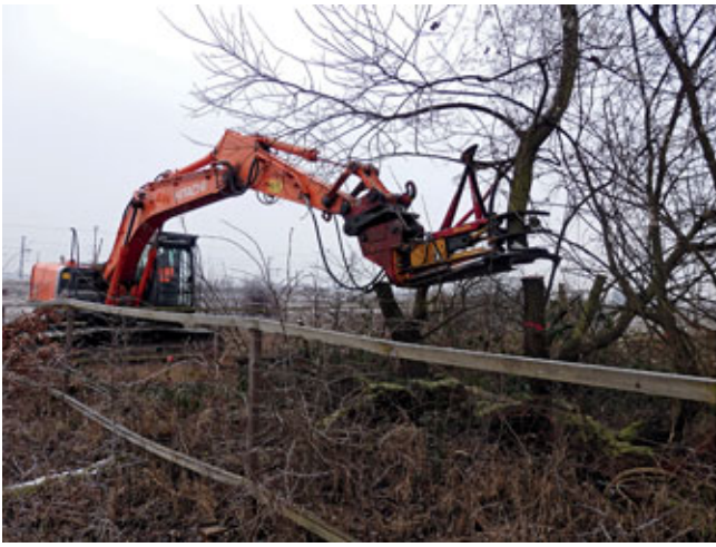
Abb. 53 u. 54: Behutsame Entbuschung einer Reptilienschutzzone mit einem hydraulischen Kneifer (Fotos: Ina Blanke)
